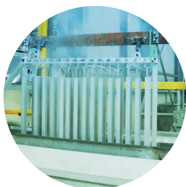
Гальванический цех RAVAK Анодирование алюминиевых профилей - производство самых прочных профилей душевых уголков, дверей и шторок для ванн.
