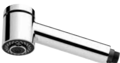
IPURI Geschirrbrause 1/2" mit Luftsprudler M24x1 und automatischer Umstellung Strahl/Brause
