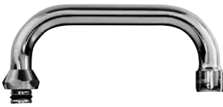
U-Rohrauslauf schwenkbar, Anschlussverschraubung IG3/4", mit Luftsprudler M22x1, Ausladung 200 mm
