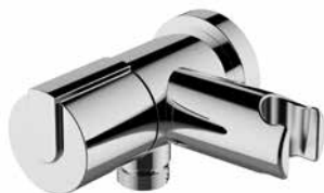
Style Schlauch-Wandanschlußwinkel DN15 mit integriertem Absperrventil und Handbrausehalter mit Rosette, Wandanschluss AG 1/2", Brauseanschluß AG 1/2" mit Rückflußverhinderer, Absperrventil mit Keramik-Innenoberteil, Halter für Handbrausen in Verbindung mit konischer Schlauchmutter 1/2"
